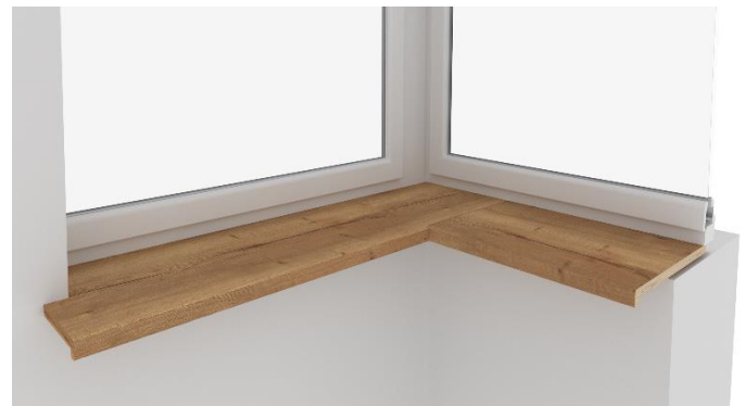
Рис. 7.12. Підвіконня із з'єднанням під 90° “єврозапил”.
